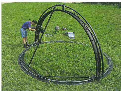
(a) transportables Feld-Goniometer im Einsatz [Alberz, 2001]
