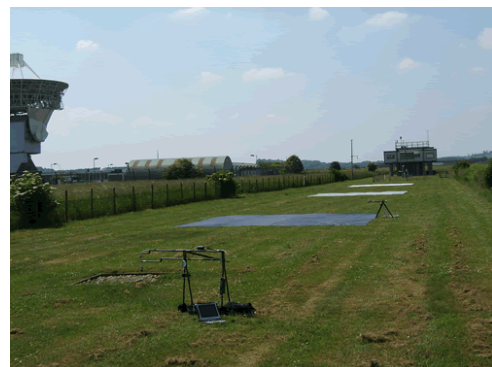
(b) Abdeckplanen zur Kalibrierung einer Satellitenaufnahme [NCAVEO, 2012]
