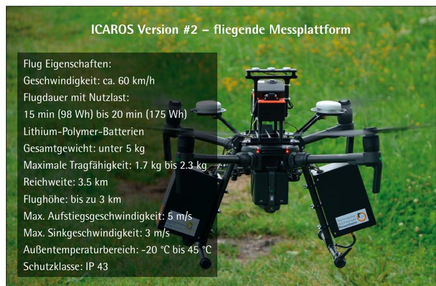
Bild 1: Das Bild zeigt den verwendeten Quadrocopter (DJI Matrice 210 RTK) mit einem Gesamtgewicht unter 5 kg und einer maximalen Traglast von 2,3 kg. Schön zu sehen sind der Top-Case als Sensorplattform – auch für weitere, neue Sensoren und die beiden Side-Cases oder Pollensäcke mit der Mess- und Kommunikationstechnik.
