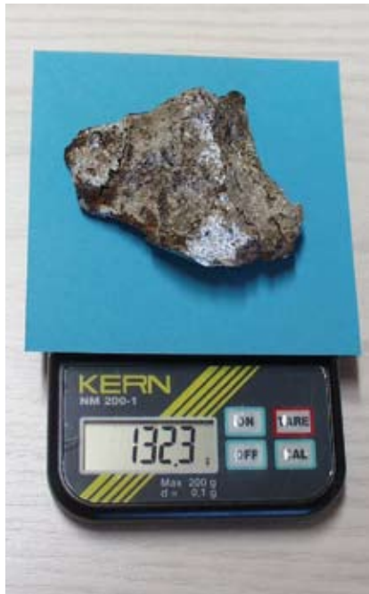
Abb. 4. Diese Metallprobe wurde im MPI für Kernphysik, Heidelberg auf ihre radioaktive Reststrahlung untersucht. Sie ist eindeutig irdischen Ursprungs.
