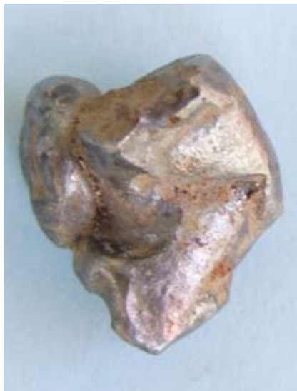
Abb. 3. Die Eisensilizid-Kügelchen aus \text{Fe}_3\text{Si} (Guepilit) und \text{Fe}_5\text{Si}_3 (Xifengit) stammen wohl eher aus der ortsansässigen Industrie als von einem Kometen.
