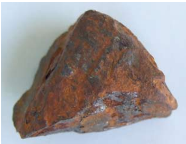
Abb. 2. Bei den würfelförmigen Eisenbrocken handelt es sich nicht um Meteorite, sondern um Produkte der Eisenerzverhüttung.
