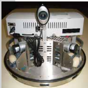
Der für die Studienarbeit verwendete mobile Roboter 'Robotino' mit Webcam und drei getrennt voneinander ansteuerbaren Antriebseinheiten, Kollisionsschutzsensor und 9 Abstandssensoren
