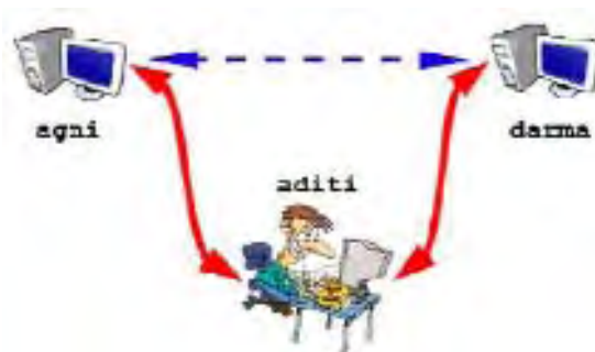
Abb. 3: Belauschen einer SSL-Verbindung durch einen Man-in-the-middle-Angriff
