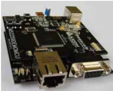
Bild 1: Eingesetzte Mikrocontroller-Platine im Fach Maschinennahe Programmierung (Freescale M52259DEMO)
