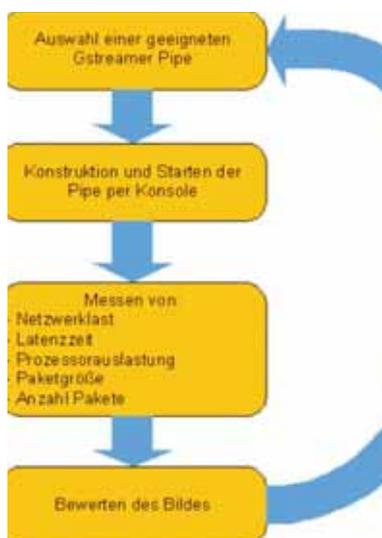
Abb 1: Ablauf bei Evaluation der Pipes
