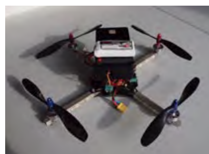
Bild 1: Quadrocopter mit Telemetrie-Box zur Datenübertragung
