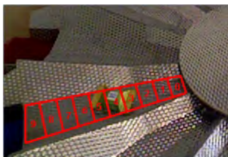
Abb. 1: Rinne einer Mehrkopfkombinationswaage mit Produkt, eingeteilt in verschiedene Abschnitte
